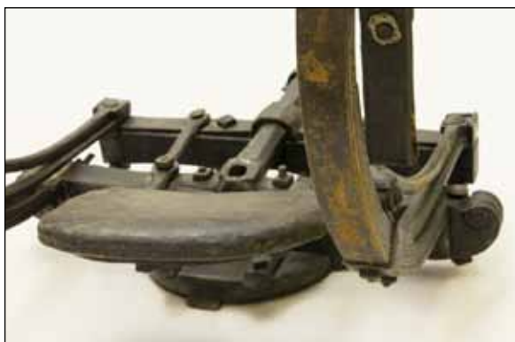
Задние ось и рессора в процессе реставрации (вид сзади)
