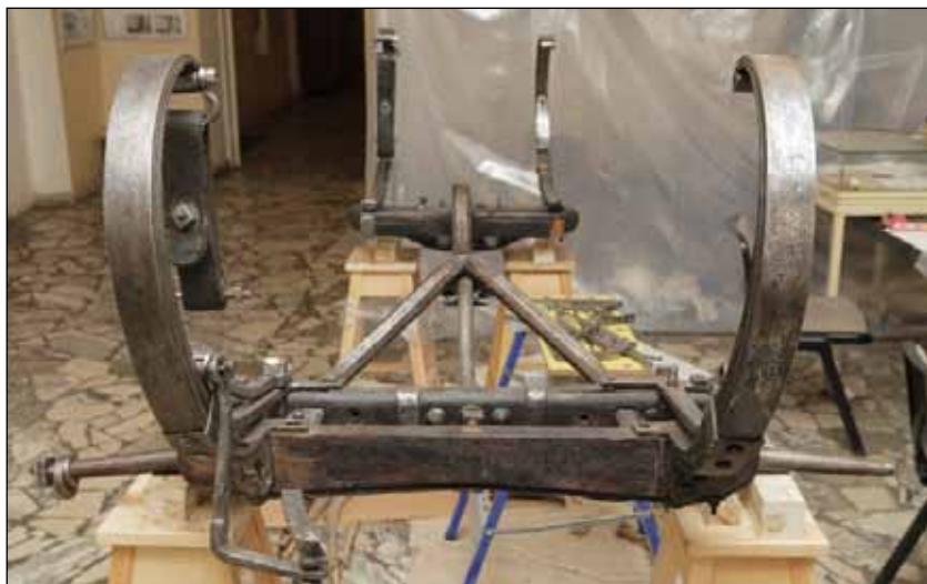
Задние ось и рессора (на переднем плане) и несущая конструкция экипажа в процессе реставрации
