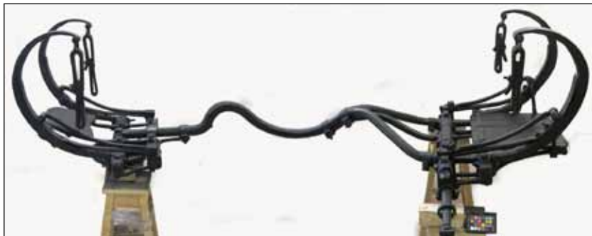
Несущая конструкция экипажа в сборе после реставрации
