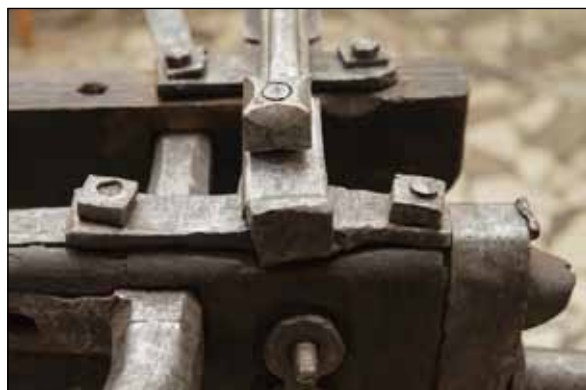
Крепежные элементы задней оси в процессе реставрации
